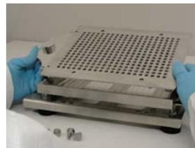
6. Placez un nouveau jeu de lamelles de corps de gélules sur la base de remplissage
