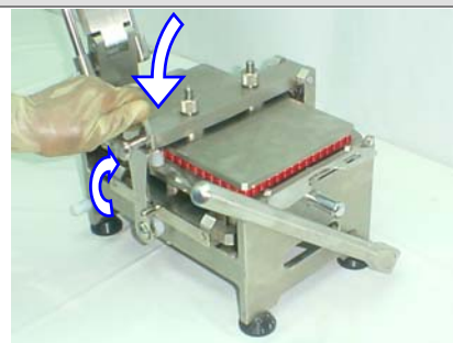
3. Soulevez la plaque de fermeture. Fixez-la avec la pince de fermeture en C qui est sur le devant du gélulier. Vérifiez que la poignée du levier est sur la position 0.
