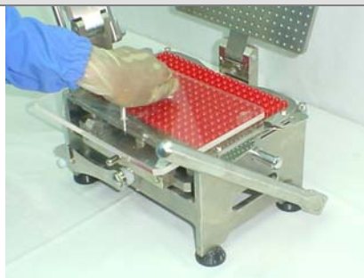
2. 19. Mettez le plateau des têtes avec la plaque poussoir sur le gélulier. Glissez la plaque poussoir pour la dégager du plateau des corps. Ne la soulevez pas, cela pourrait retirer les têtes des gélules du fait de l'électricité statique.
