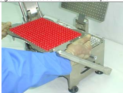
5. Débloquez la pince de fermeture en C et soulevez la plaque de blocage. Retirez le plateau des têtes et vous obtenez des gélules remplies et fermées ! Voir astuce n° 3.
